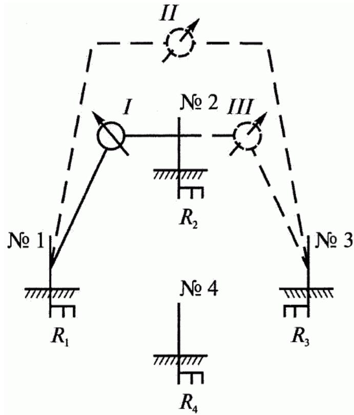
Рисунок 17. Схема измерения сопротивления заземлителей способом трех измерений
