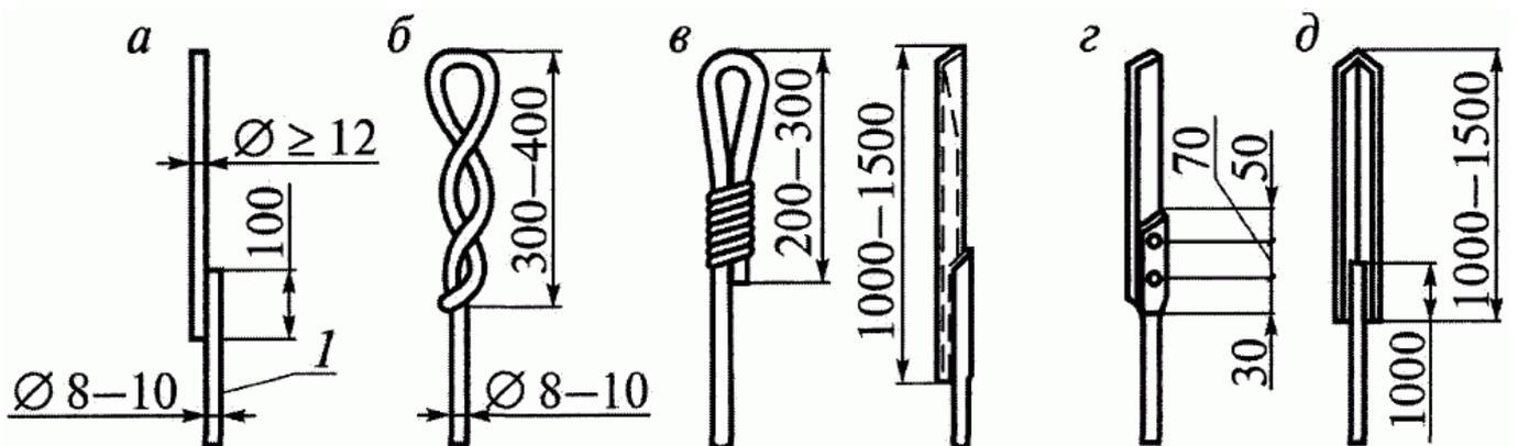
Рисунок 14. Конструкции молниеприемников из круглой стали (а), стальной проволоки диаметром 2 - 3 мм (б), стальной трубы (в), полосовой стали (г), угловой стали (д):
