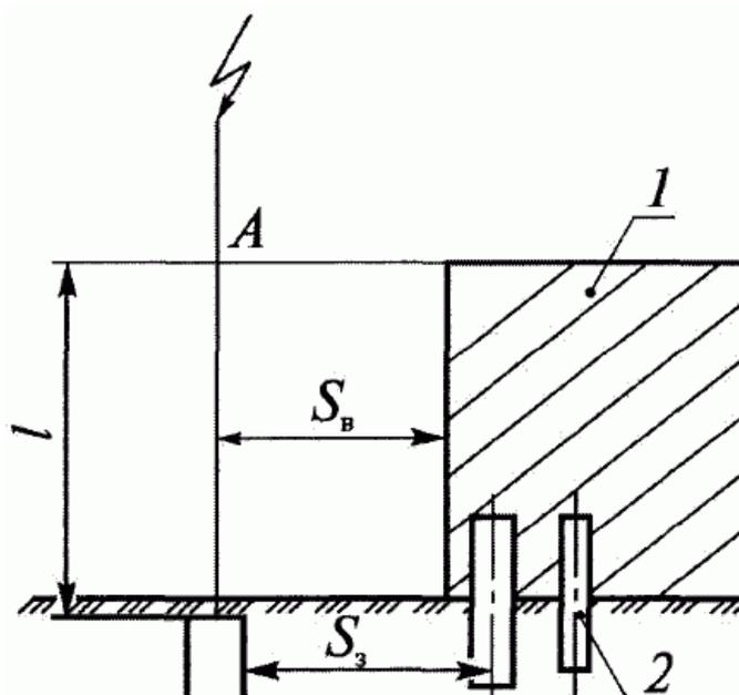
Рисунок 1. Отдельно стоящий стержневой молниеотвод:  $l$  - протяженность токопровода от точки А до заземлителя;  $S_b$  - наименьшее допустимое расстояние до защищаемого сооружения;  $S_3$  - наименьшее допустимое расстояние от заземлителя до металлических коммуникаций; 1 - защищаемое сооружение; 2 - металлические коммуникации
