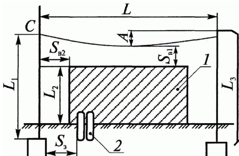
Рисунок 2. Отдельно стоящий тросовый молниеотвод:  $L$  - расстояние между молниеотводами;  $L_1, L_3$  - протяженность токопроводов;  $L_2$  - высота защищаемого сооружения;  $S_{b1}, S_{b2}$  - наименьшие допустимые расстояния от тросового молниеотвода соответственно в точках А и С до защищаемого сооружения;  $S_3$  - наименьшее допустимое расстояние от заземления до металлических коммуникаций; 1 - защищаемое сооружение; 2 - металлические коммуникации.
